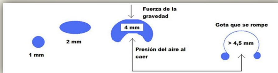
Fig.2. Imagen que muestra diferentes tamaños de gotas de lluvia y la deformación por efecto de la presión del aire al caer.
